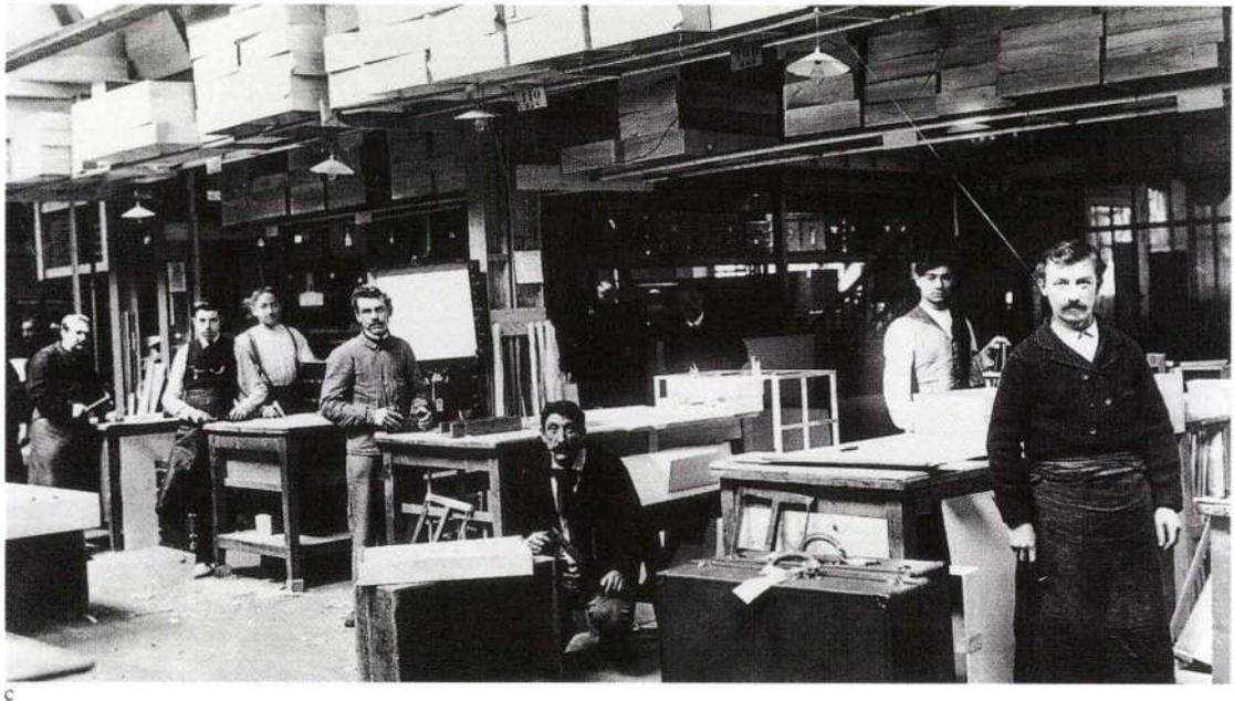
c. Atelier de finition des malles en 1909. La façon de travailler est encore aujourd'hui artisanale notamment en ce qui concerne les valises et les pièces de luxe. L'entoilage, le cloutage et la fabrication des poignées par exemple se font manuellement. Les ateliers où sont fabriqués des sacs et des collections moins traditionnelles qui nécessitent davantage de coutures, sont plus mécanisés. (Fonds Vuitton).
