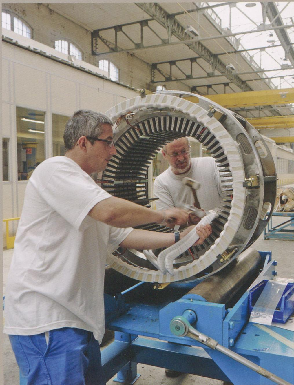
*Jeumont-Electric, atelier de bobinage. La bobine est placée dans les encoches d'une lanterne de stator empilée.*
