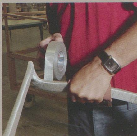
*Jeumont Electric, atelier de fabrication des bobines. Un geste traditionnel : les navettes de fils de cuivre, ou « bobines », sont enveloppées manuellement de ruban isolant, appelé « papier de mica ».*
