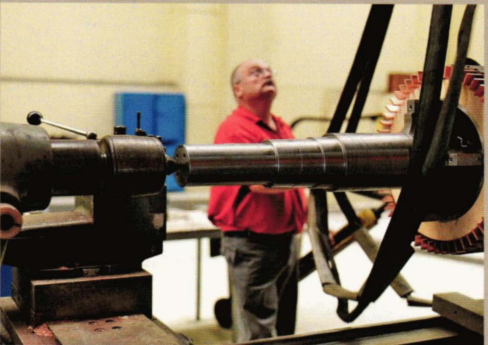
*Jeumont Electric, atelier d'usinage. Positionnement du rotor sur le tour : l'extrémité des barres de cuivre doit être usinée et ajustée avant l'assemblage des cercles.*
