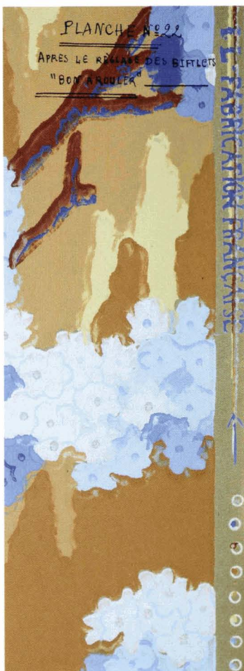
Échantillon de papier peint avec ses canons et picots servant de repères pour les réglages des machines. Lorsque la machine était réglée, le picot de couleur était parfaitement au milieu du canon. Le « bon à rouler » était délivré.
