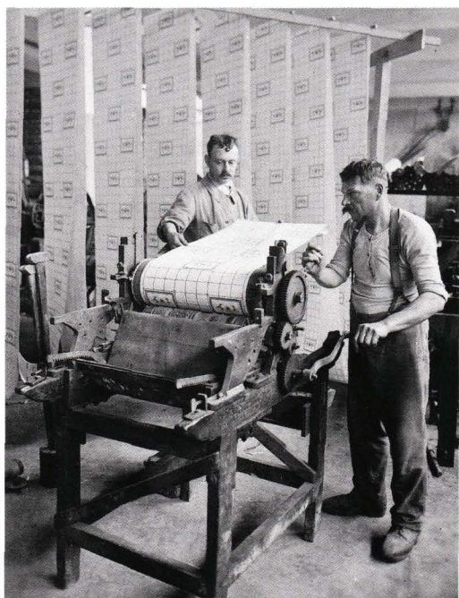
Machine à imprimer à 1 cylindre, équipée du système du drap sans fin, inventée par Isidore Leroy en 1844, tirage photographique, non daté.
