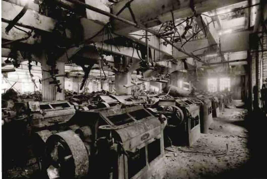
← La salle des appareils à cylindre Buhler après l'incendie, août 1944. (Photo Chevojon, coll. part.).
